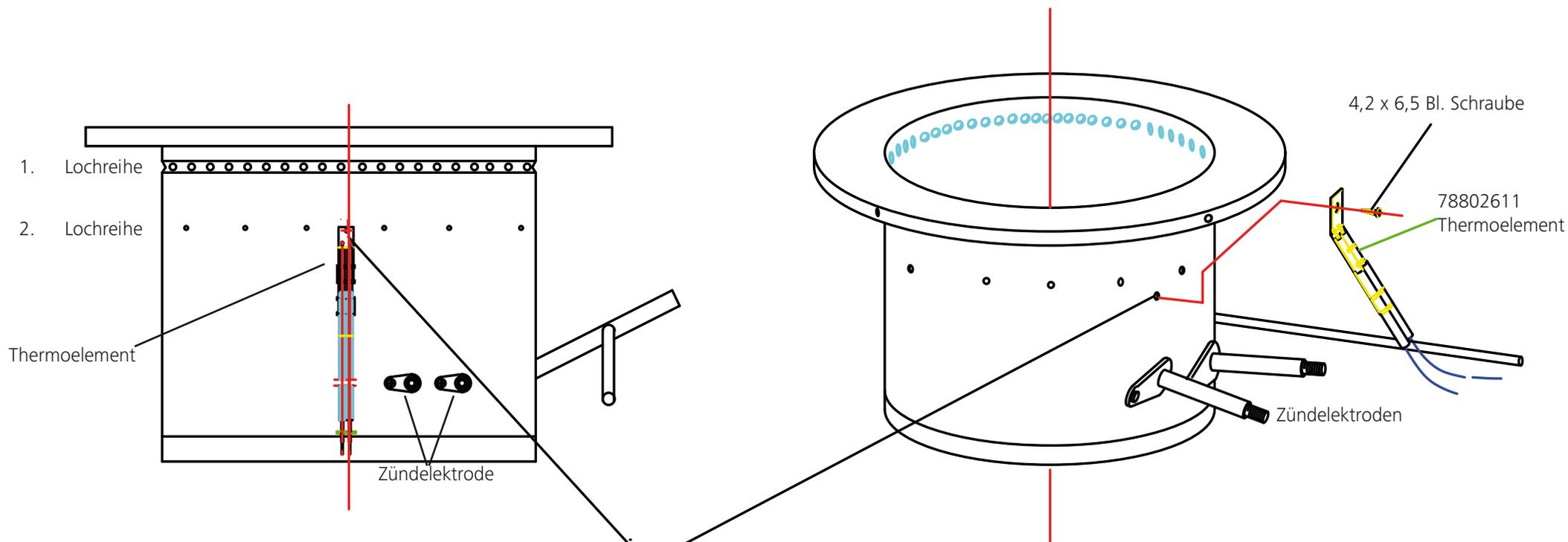
Thermoelement unterhalb der 2. Lochreihe mit Blechschraube 4,2 x 6,5 mm befestigen
