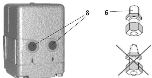
6. Verschlussstopfen [8] von der Rückseite des Ölzählers entfernen und Einschraubzapfen [6] mit zylindrischem Gewinde eindrehen.
